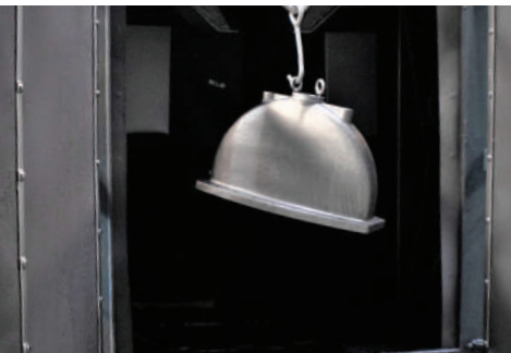
Çelik Grid Kumlama Sa2.5 Yüzey kalitesi
