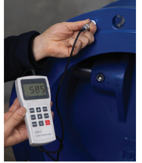
Kaplama Kalınlığı Ölçümü
