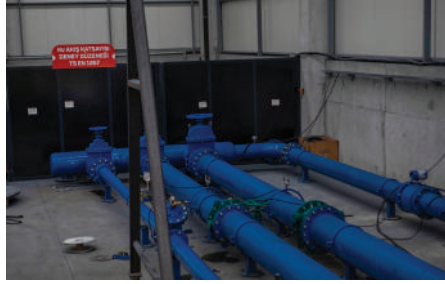
TS EN 1267 Kv Ölçme Düzeneği
